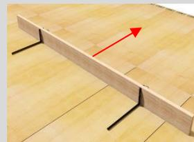
Aligner les équerres Randfix sur le coffrage et les clouer avec trois clous en aluminium Ø3.1 x45 mm.
