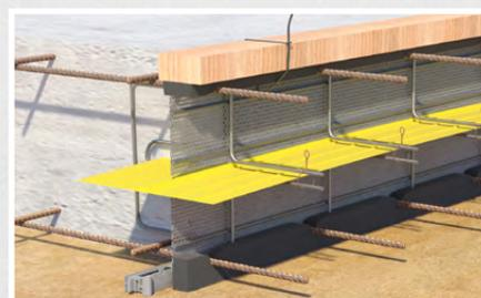
Le caoutchouc de coffrage Schalflex peut aussi être tendu vers le bas avec un bois équarri et un serre-câble
