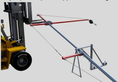
Introduire la fourche du chariot dans les ouvertures du support de montage et serrer avec des vis à ailettes.
