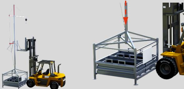
Desserrer les quatre vis à ailettes du support de montage et retirer celui-ci du mât. Une échelle est nécessaire pour atteindre le support de montage.
