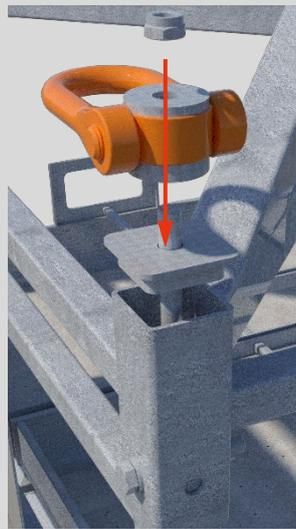
Serrez le pivot d'arrêt avec l'écrou Poly-Stop M16. Torque de serrage = 60 Nm
