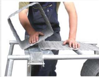
Sectionner la quatrième arête en pliant plusieurs fois vers le bas et en repliant dans l'autre sens.
