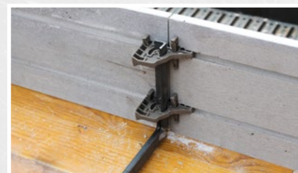
Die Deckenwinkel sind mit den Läufern stufenlos in der Nut der Platte verschiebbar. Die Elemente können so optimal in der Längsrichtung kraftschlüssig verbunden werden
