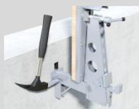
S'assurer que la console BKA Pro est correctement placée dans la réservation BKA Pro une fois montée et bloquée.
