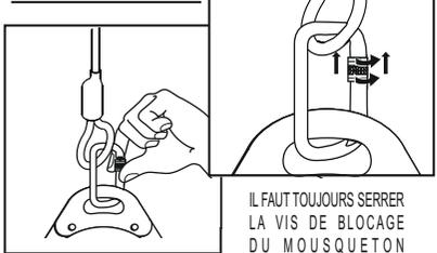
Le point de structure fixe auquel le connecteur à corde est attaché doit avoir une résistance minimale de 15 kN, doit être localisé au-dessus du poste de travail et sa construction doit rendre impossible le passage ou la déconnexion autonome du connecteur à corde. Il est conseillé d'utiliser les points de structure marqués et certifiés, conformes à la norme EN 795.
