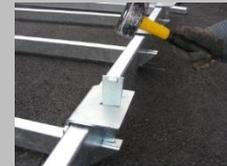
Assembler les longerons porteurs avec les faces, puis les visser avec les vis et écrous à levier M20 x 90 mm livrés.
