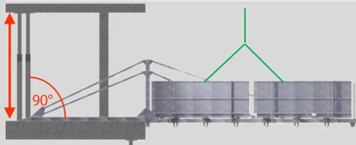
Bloquer les longerons porteurs avec un boulon d'ancrage DW Ø15 mm.
