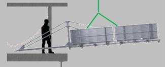
La Plateforme MS extrême XL 3000 doit complètement être appuyée contre l'arête de béton de façon à ne pas affecter la répartition des forces selon la statique calculée. Les longerons porteurs doivent être montés à angle droit par rapport à l'arête de béton. En hiver, s'assurer que les zones d'appui des longerons porteurs soient complètement libres de neige et de verglas.
