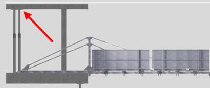
Procéder à l'étalement nécessaire et prendre les mesures de sécurité nécessaires pour éviter tout glissement (en concertation avec l'ingénieur civil local).
