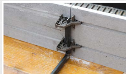
Les équerres peuvent être déplacées en continu dans la rainure de la plaque grâce aux coulisses. Les éléments peuvent être ainsi solidement assemblés dans le sens longitudinal
