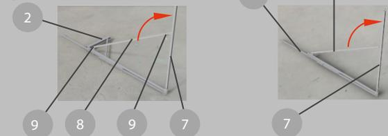
Monter le support (pos. 11) sur le support d'assurance rigide (pos. 3,4).
