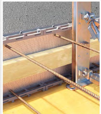
*Pour des exigences élevées, Net-Form peut aussi être tourné et bloqué au milieu avec un bois équarri. Après le décoffrage, il reste une surface optimale pour monter un tuyaux ou un canal d'injection.*
