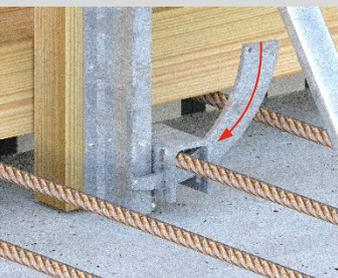
Régler l'angle avec l'entretoise et caler contre l'armature inférieure avec une cale courbée.
