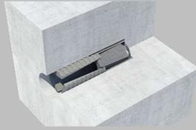
Visser la barre d'ancrage DW dans l'ancre de roche jusqu'en butée.
