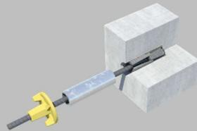
Serrer l'écrou au marteau jusqu'à ce qu'il ne tourne plus.
