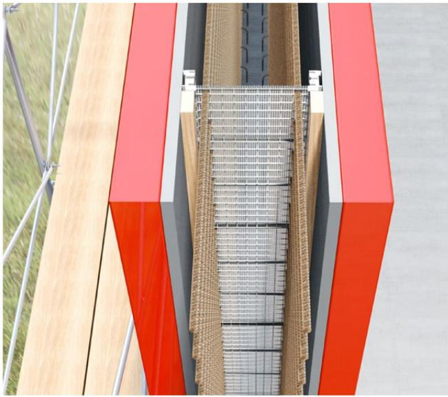
Pour des épaisseurs de murs de 18 à 25 cm, Net-Form se fixe simplement sur le coffrage mural et est calé des deux côtés par une planche.
