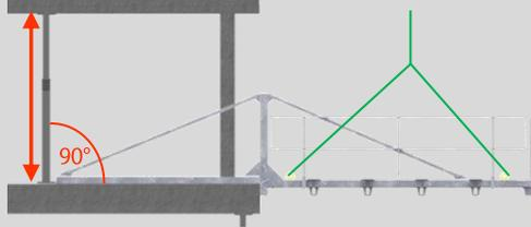
Bloquer les longerons porteurs avec un boulon d'ancrage DW Ø15 mm.
