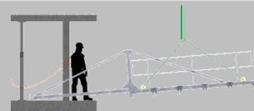
La Plateforme MS extrême 2000 doit complètement être appuyée contre l'arête de béton de façon à ne pas affecter la répartition des forces selon la statique calculée.
