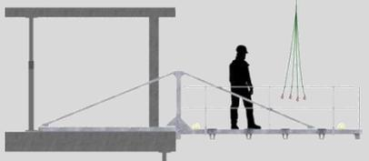
Si des tables de coffrage sont sorties et rentrées, les étais contre la face inférieure de la dalle doivent également être sécurisés avec un boulon d'ancrage DW Ø15 mm.
