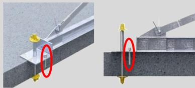
Les étais de dalle ne doivent pas être appuyés en haut sur une poutre ou des bois équarris mais uniquement sur la peau de coffrage ou directement sur le béton de la dalle.
