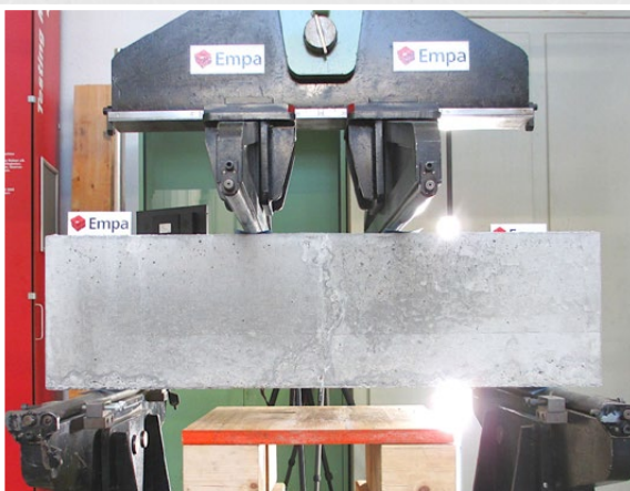
Détails de l'application de la charge et des appuis (essai de flexion)
