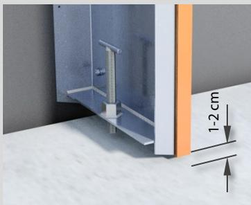
Accrocher les tubes télescopiques sur le côté opposé. Les bloquer à l'aide des goupilles et les aligner avec la broche filetée.
