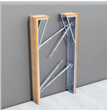
Il est recommandé de fixer le Porta-Form entre 1 et 2 cm du sol pour faciliter le décoffrage. La distance peut être réglée à l'aide de l'étau DW.
