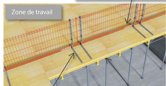
Côté du plus long du pied mobile en direction du bord de chute
