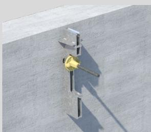
Vérifier que les adaptateurs BKA Pro sont alignés verticalement et qu'un écartement maximal de 2.00 entre eux est respecté.
