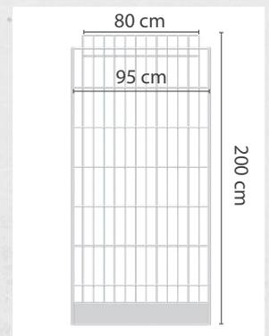
Porta-Net a une largeur de 80 cm côté accrochage et de 95 cm côté arrêt.
