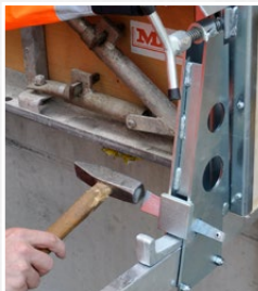
Bloquer la cale transversale du chariot
