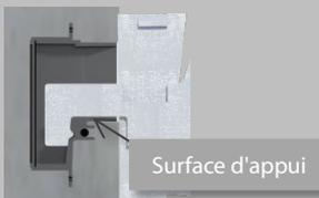
Faire reposer le support de plinthe sur la dalle en béton.
