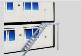
Monter la rampe d'escalier et le garde-corps du palier.
