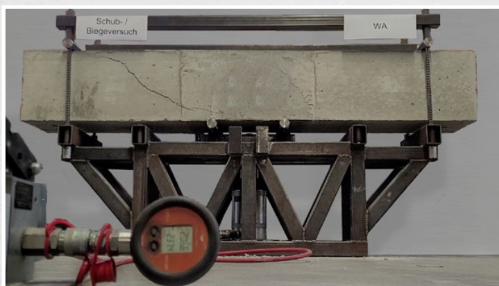
Succès pour essai de cisaillement-flexion
