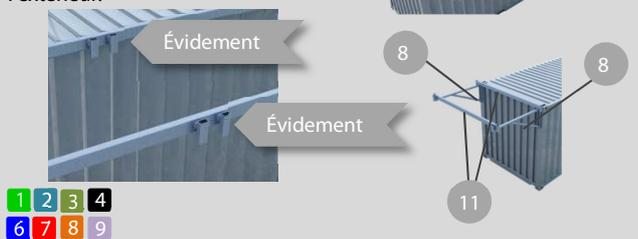
Poser le longeron porteur longitudinal (pos. 11) à l'arrière sur la console porteuse (pos. 8) et la console porteuse pour montage central (pos. 14). Fixer le longeron porteur longitudinal à la console porteuse pour montage central (pos. 14).
