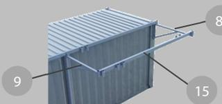
Poser les plateformes (pos. 16) les plus à l'extérieur sur les longerons porteurs (pos. 10, pos. 11 ou pos. 15).
