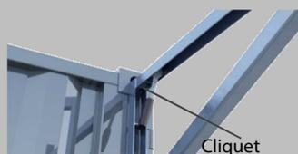
Poser les longerons porteurs (pos. 10 ou pos. 11) à l'avant et à l'arrière sur la console porteuse (pos. 8). Les évidements pour les rampes du longeron porteur doivent être tournés vers l'extérieur.
