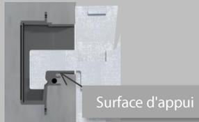
Faire reposer le support de plinthe sur la dalle en béton.
