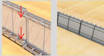
Pour des épaisseurs de paroi de 18 à 26 cm, le Net-Form comporte une seule ferrure transversale. Lors du montage du Net-Form, veiller à placer la ferrure transversale en haut pour pouvoir y placer plus tard l'armature supérieure.
