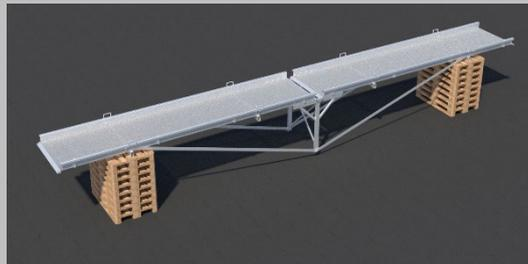
Mettre en place les montants et les planches de sécurité selon la procédure de montage de la Sky-Bridge.
