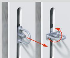
Faire glisser le Porta-Panel dans la largeur et le placer sur le dispositif de blocage droit.
