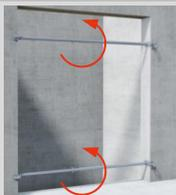
Placer le Porta-Panel gauche sur le dispositif de blocage. Le profilé en U fixé sur le Porta-Panel Air doit être contre le Porta-Fix Air.
