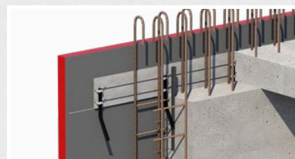
Après le bétonnage du mur, le coffrage des rives de dalle est terminé
