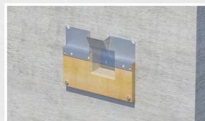
Position optimale de l'orifice de coulée
