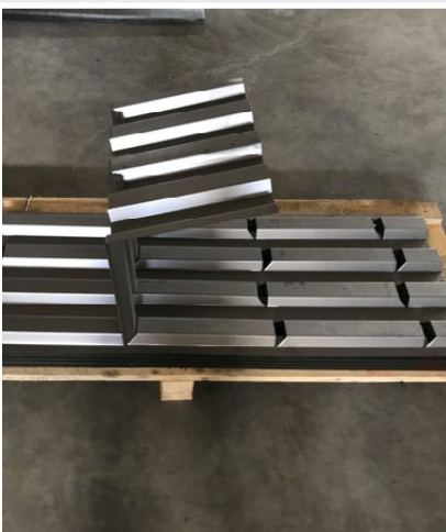
Einfaches falten dank Soll-Biegestelle
