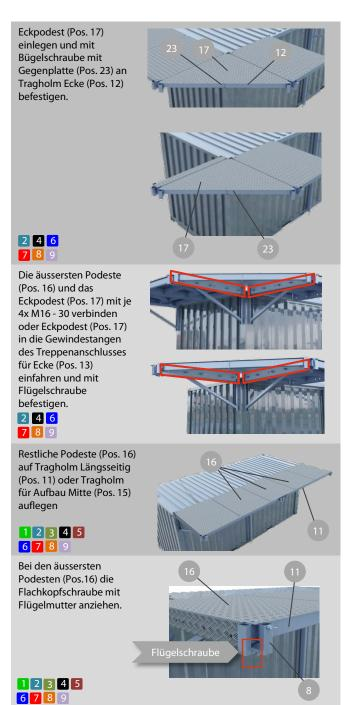
Podeste (Pos. 16 oder Pos. 17) mit Bügelschraube mit Gegenplatte (Pos. 23) an Tragholm (Pos. 10, 11, 12 oder Pos. 15) befestigen.
