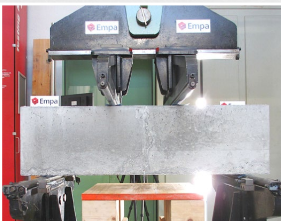
Details der Lastaufbringung und der Auflager (Biegeversuch)
