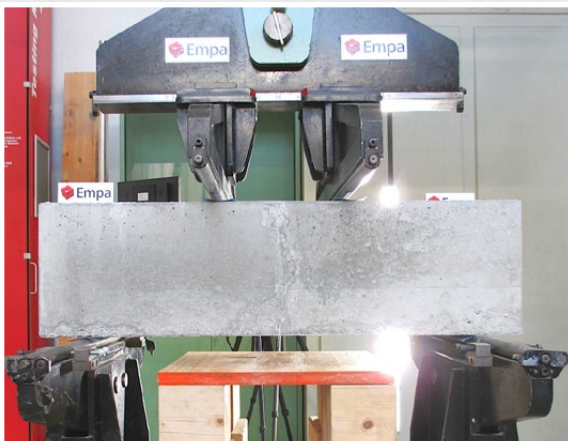
Details der Lastaufbringung und der Auflager (Biegeversuch)
