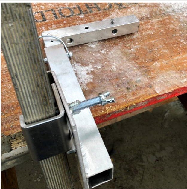
Die Klemmbacken können Leiterholmen mit einer Tiefe von 6-12 cm und einer Breite von 0-2.5 cm aufnehmen
