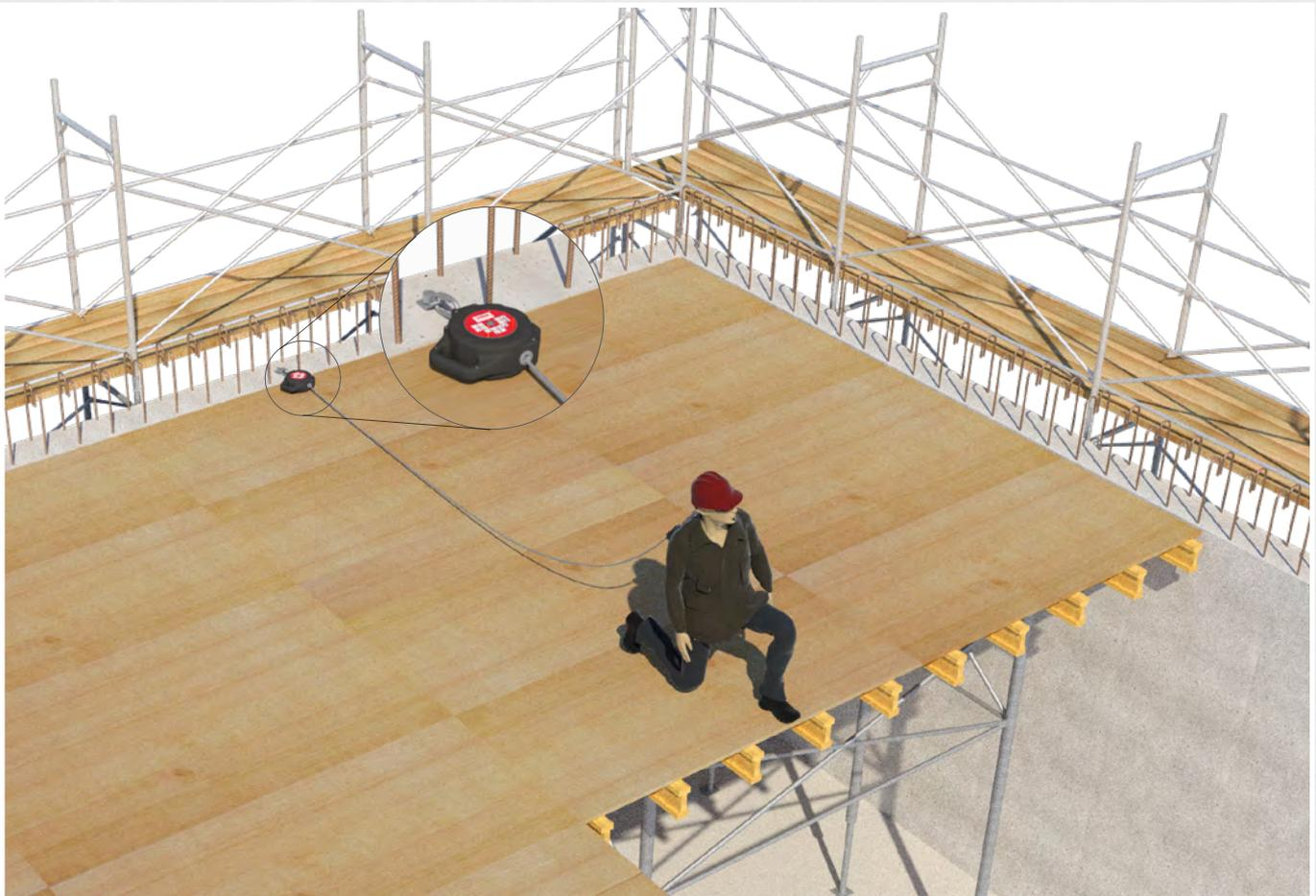
Der KiBo Anschlagpunkt Steinadler kann in der Wandkrone befestigt werden und dient so als Anschlagpunkt beim Versetzen von Deckentischen ab 3.50 m Absturzhöhe. Beim Schalen von Decken unter dieser Höhe empfehlen wir unsere bewegliche Anschlagrichtung Life-Gard.
