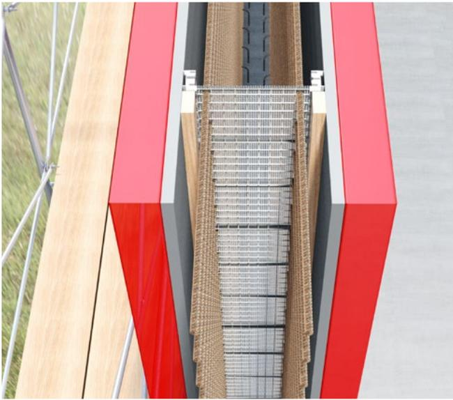
Bei Wandstärken von 18 -25 cm wird das Net-Form einfach auf die Wandschalung aufgenagelt und beidseitig mit einer Latte gesichert.
