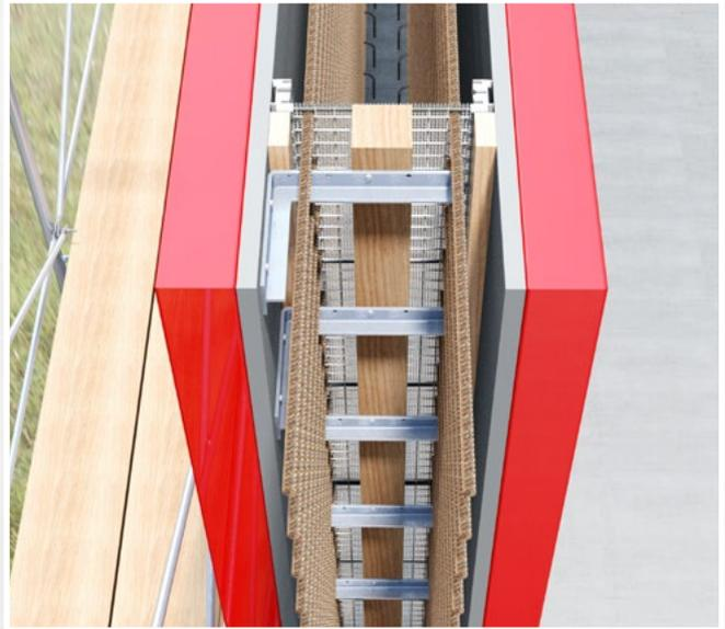
Ab einer Wandstärke von 28 cm wird das Net-Form für Wände in der Mitte zusätzlich mit einem Kantholz gesichert. Für die Befestigung des Kantholzes empfehlen wir die Verwendung unserer Leibungsschalungswinkel.
