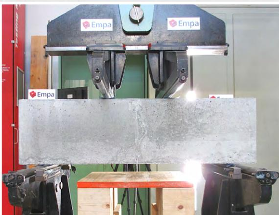
Details der Lastaufbringung und der Auflager (Biegeversuch)
