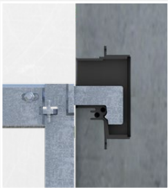
Kontrolle ob die Konsole richtig aufliegt
