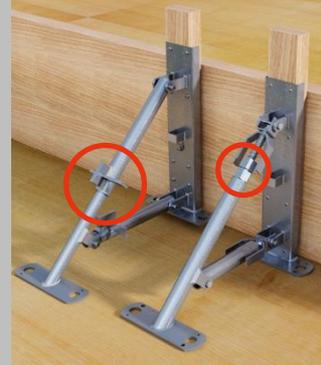
Um die Rundeisen nicht ganz einschlagen zu müssen kann optional die Fer-Clip Spannklemme Art. 1509 verwendet werden oder es können Holzstücke zwischen dem BPA Fuss und dem Nocken des Rundeisens eingeklemmt werden.
