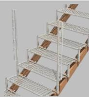
Das Seitenschutzgeländer mit Holzplatten erstellen und mit Keilen oder Nägeln unverrückbar befestigen.
