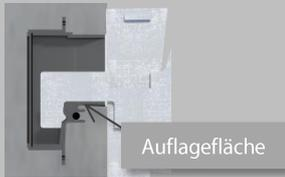
Bordbretthaken auf Betondecke aufliegen lassen.
