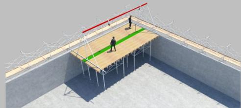
**Schritt 5** Deckentische und Ausgleichselemente um zwei Felder erweitern.
