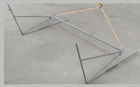
Aufklappen beider gegenüberliegenden Stützfußkonstruktionen und arretieren der Streben (Pos. 8) mit Steckbolzen (Pos. 9).
