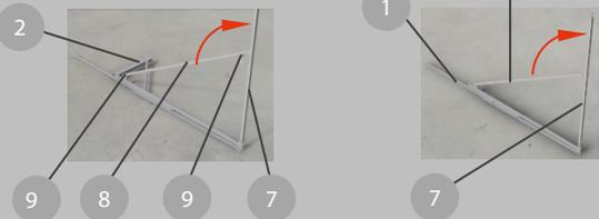
Montieren der Halterung (Pos. 11) an die feste Führung (Pos. 3,4).
