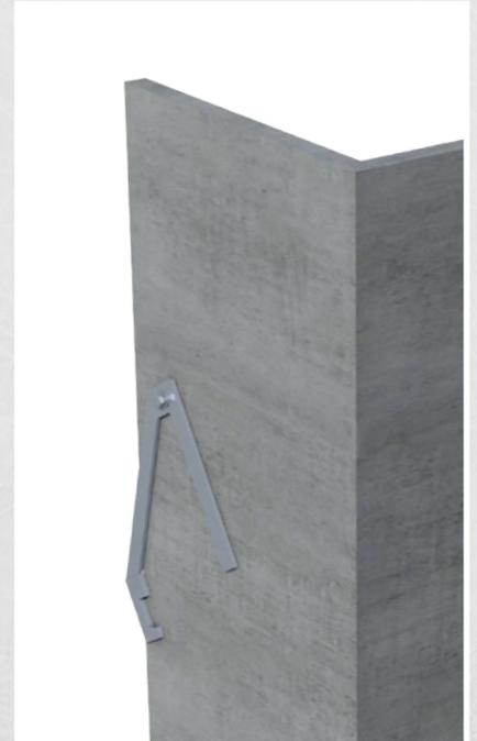
*BKA Pro Schachtfix Haken lose montieren. Bei Isolation Distanzhalter befestigen. Lichtschacht versetzen, ausnivellieren und Schrauben fest anziehen*
