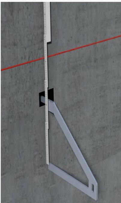
*BKA Pro Schachtfix Haken in die einbetonierte Aussparung einhängen. Mass von Hakenauflage bis OK Terrain messen*
