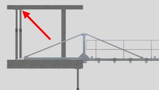
Die nötige Untersperrung vornehmen und die entsprechenden Sicherheitsmassnahmen gegen das unkontrollierte Wegrutschen treffen (Rücksprache mit dem örtlichen Bauingenieur).
