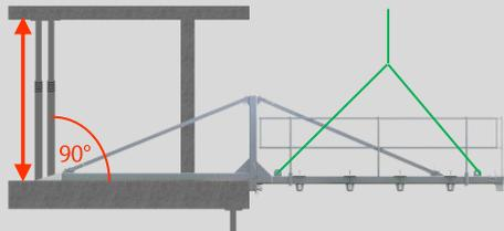
Sichern der Tragholme gegen verschieben mit je einem DW-Anker Ø15 mm.
