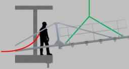
MS-Plattform Extrem 4000 muss ganz an der Betonkante angelegt werden, so dass der Kräfteverlauf, gemäss der berechneten Statik, nicht beeinträchtigt wird. Die Tragholme müssen im rechten Winkel zu der Betonkante montiert werden. Im Winter ist darauf zu achten, dass die Bereiche der Auflage der Tragholme von Schnee und Eis absolut frei sind.
