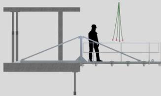
Werden Deckentische aus- und eingefahren, sind die Deckenstützen an der Deckenunterschicht ebenfalls mit einem DW-Anker Ø15 mm zu sichern.
