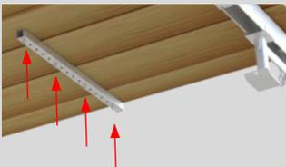
Die Stirnseite der Tiefenfixierung ist bündig zum äussersten Gerüstbrett zu positionieren
