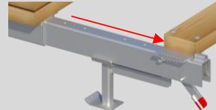
Vor dem Befestigen der Gerüstbretter, ist der Sicherungsbolzen in allen vier Ecken der Lift-Plattform in die vorgesehene Öffnung einzuführen.
