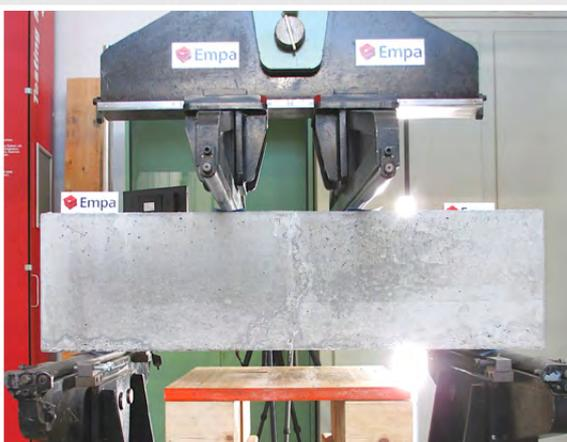
Details der Lastaufbringung und der Auflager (Biegeversuch)
