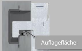
Bordbretthaken auf Betondecke aufliegen lassen.
