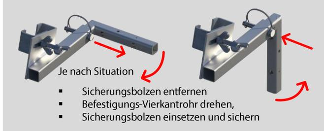
Aufnageln oder aufschrauben der Leiterhalterung auf der Deckenschalung oder der Betondecke.
